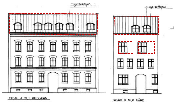
Figur 23. Bygglövsritning från ombyggnationen 1988 som visar ny takbeklädnad, förhöjt tak samt tillägg av takkupor mot gata och innergård. På fasaden mot gården syns också förändringar i fönstersättningen, vilken frångår ursprunglig symmetri.
